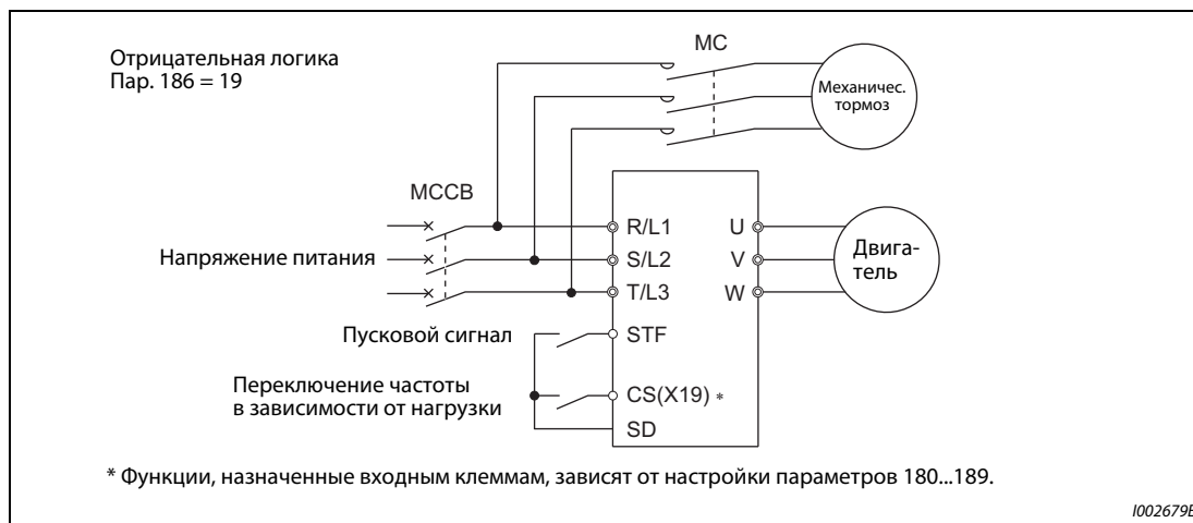
Рис. 5-227: Пример подключения с механическим тормозом
