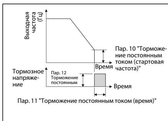
Рис. 5-316: Настройка параметра 11 на значение между 0,1 и 10 с
