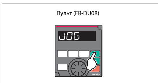
Рис. 4-13: Пример для толчкового включения с помощью пульта
