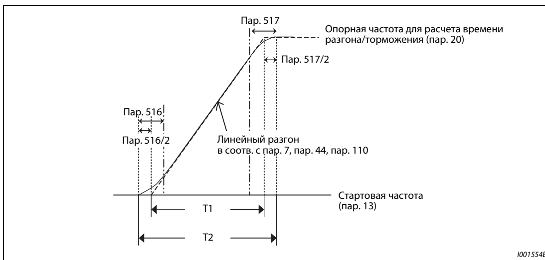
Рис. 5-90: Длительность S-образных участков характеристики при запуске
