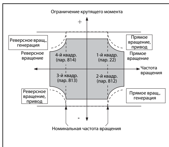
Рис. 5-14: Задание ограничения крутящего момента с помощью параметров
