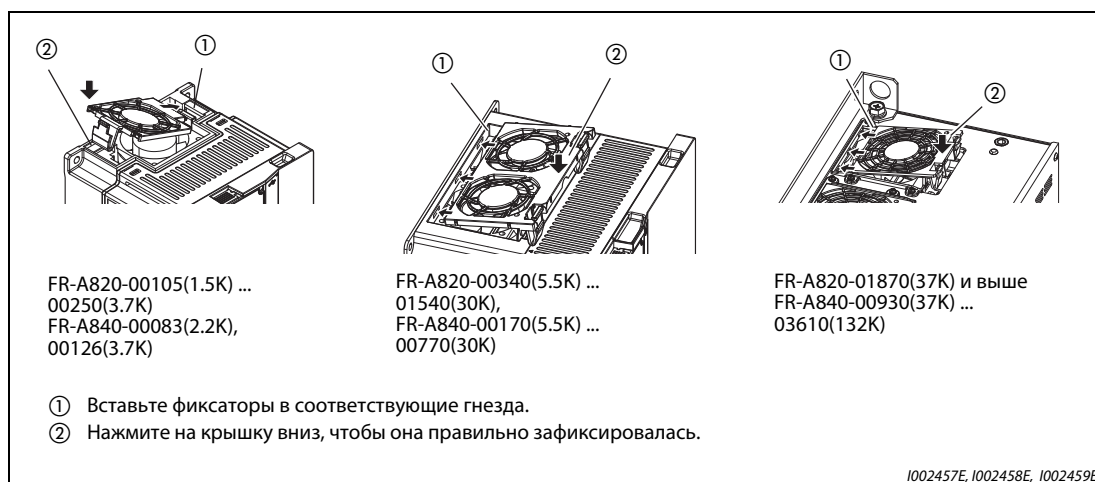
Рис. 7-6: Монтаж кожуха вентилятора
