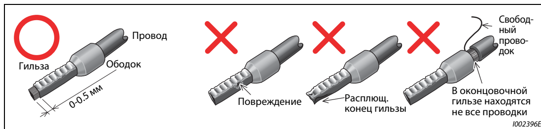
Рис. 2-28: Опрессовка оконцовочной гильзы
